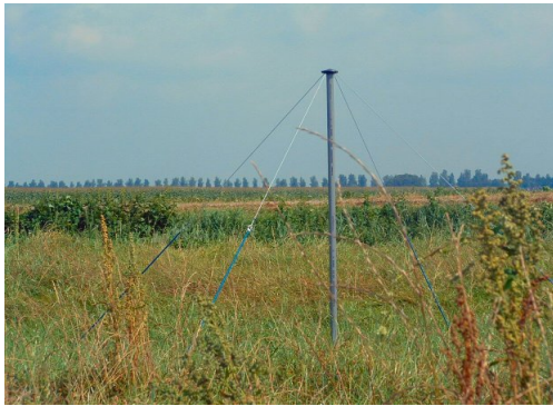
Fig. 2.3: Low band antenna.
